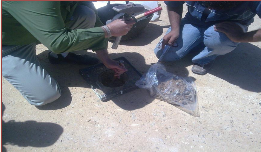
الفحوصات المخبرية فحص درجة رك على المحطه ١٠+٢ لطبقة Sub Grade على Road
